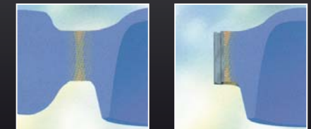
Lötfolge – Auswirkungen auf das Gefüge der Lötung.
