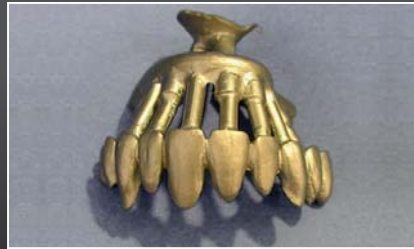
Angestiftetes Massivteil aus Edelmetall nach dem Guss.
