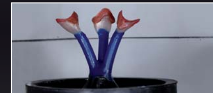
Wachsmodell auf Heraeus Gusstrichterformer: Ausrichtung der Modellation mit Anstifthilfe (Plexiglas - Halbschale).
