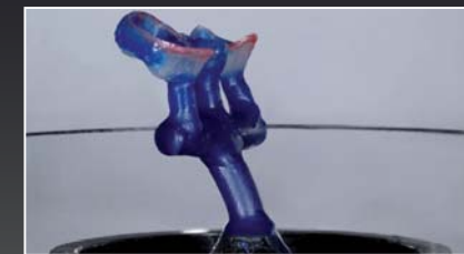
Anstiftung eines Wachsmodells, Querbalken waagrecht auf halber Muffelhöhe platziert.
